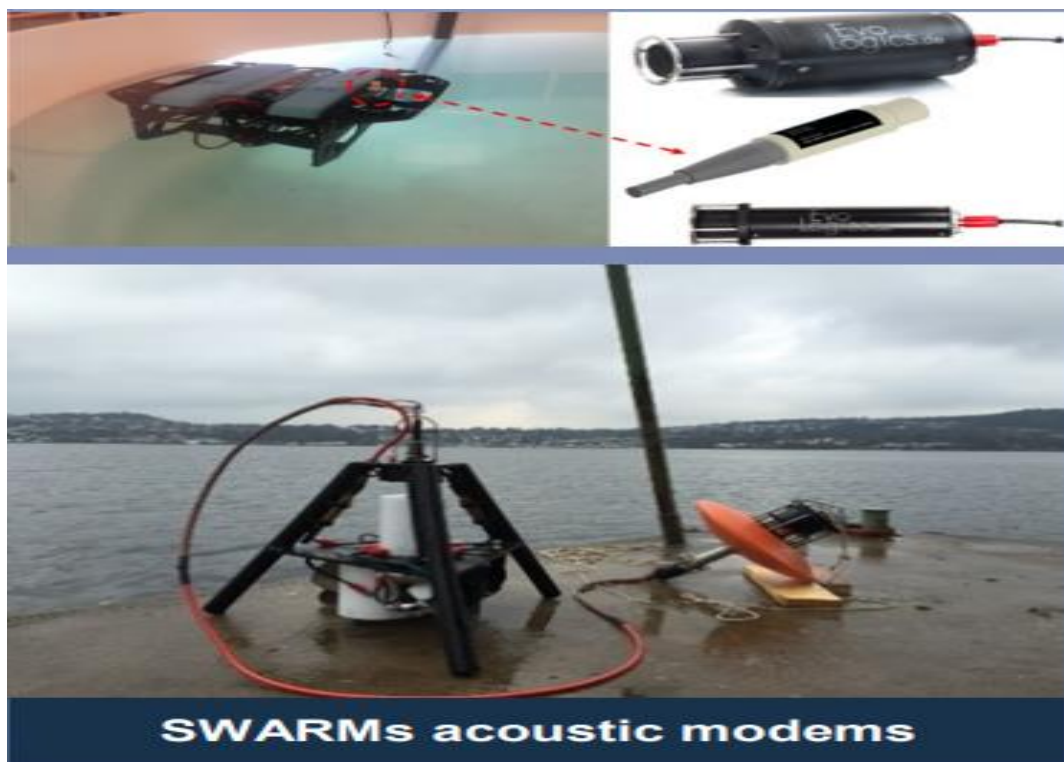
Εικόνα 5.2: Ακουστικά modem εφαρμογής SWARMS [59].
