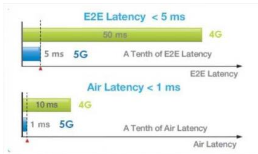
Σχήμα 4 – Σύγκριση του χρόνου καθυστέρησης μεταξύ του δικτύου 4G και του 5G
