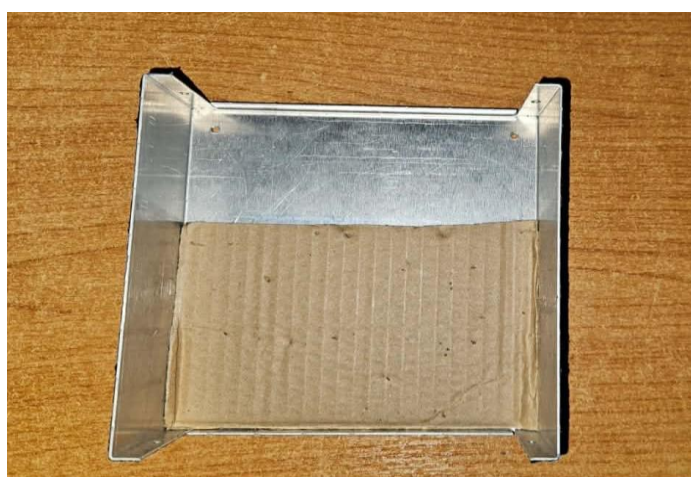
Εικόνα 5.4.2 Μόνωση Της Κάτω Επιφάνειας
