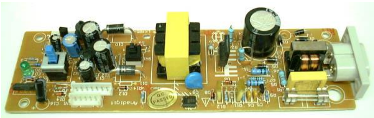
Εικόνα 4.1.5 Εσωτερικό Τροφοδοτικό PS1
