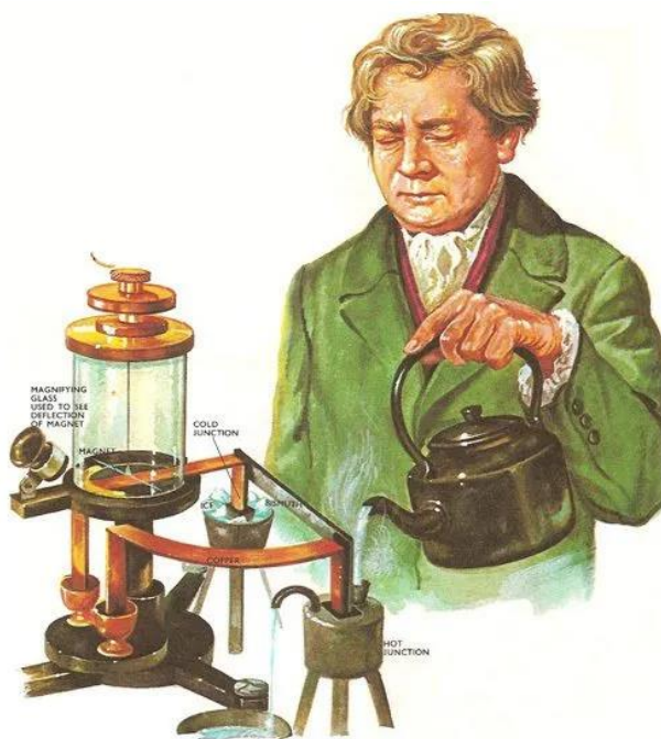
Εικόνα 2.2.2 Ο Georg Ohm επί το έργον: (Πειραματική διάταξη μέτρησης του ρεύματος που διαρρέει χάλκινη αγωγήμη ταινία)
