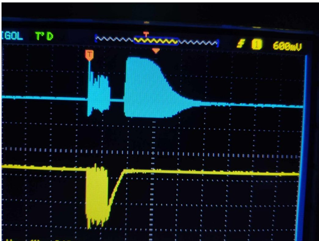
Σχήμα 2.52 Τάση αισθητήρα (κίτρινο), τάση εξόδου ενισχυτή(μπλε), χωρίς εμπόδιο
