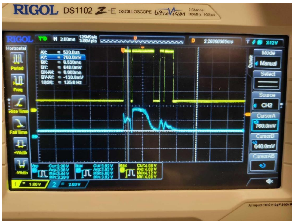
Σχήμα 2.54 Έξοδος ενισχυτή(μπλε), τάση αισθητηρίου(κίτρινο), με επιστροφή
