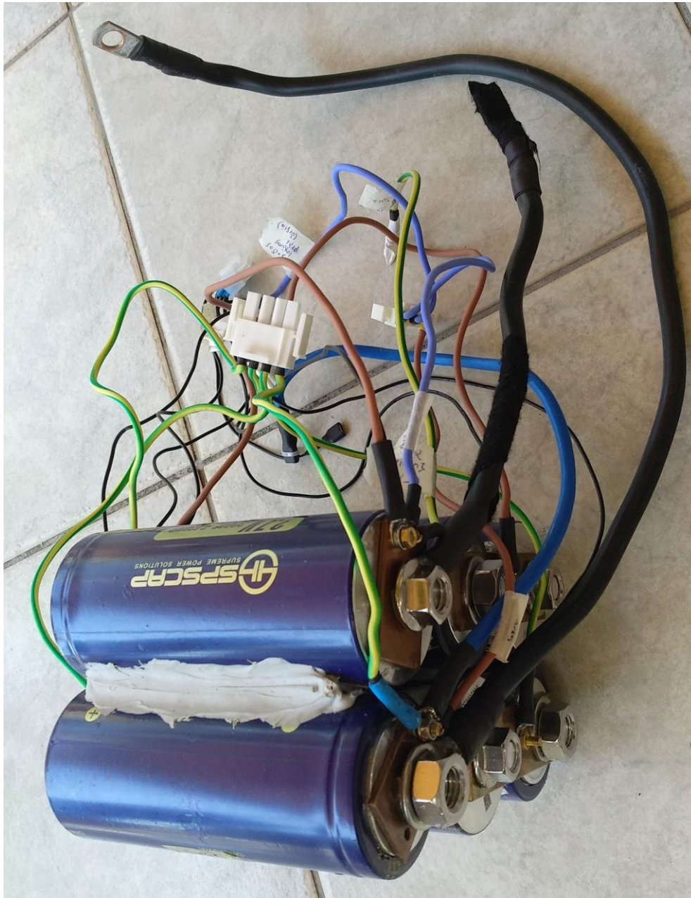
Εικόνα 6.1 : Συστοιχία υπερπυκνωτών με τις απαραίτητες καλωδιώσεις
