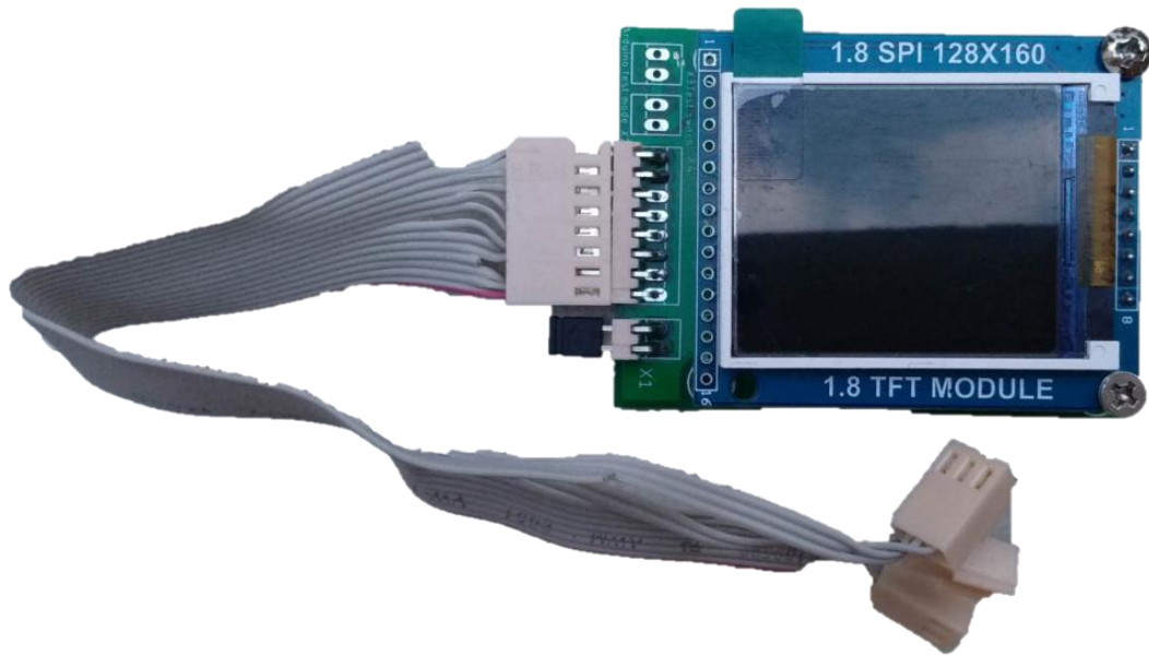
Εικόνα 5.41 : Τελική μορφή οθόνης μαζί με την βοηθητική πλακέτα και την καλωδιοταινία
