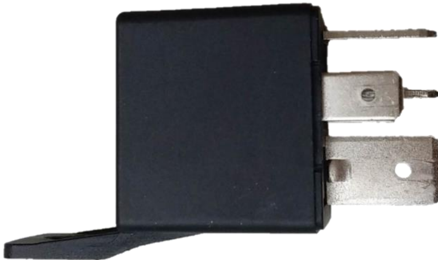
Εικόνα 4 8 · Ρελέ AM3-12CF για την απομόνωση της μπαταρίας
