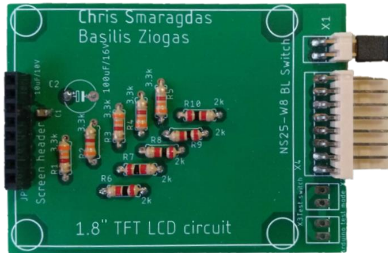
Εικόνα 5.39 : Άνω όψη βοηθητικής πλακέτας οθόνης
