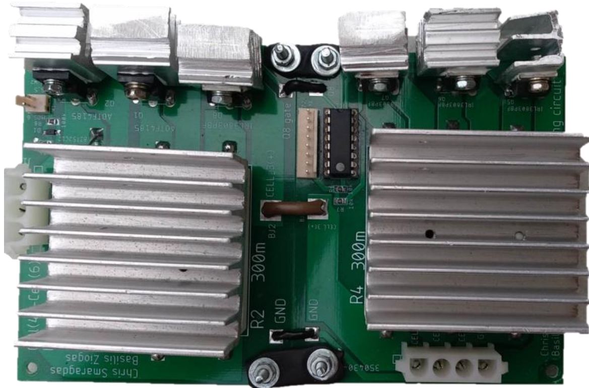
Εικόνα 5.36: Πλακέτα προστασίας και εξισορρόπησης με ψήκτρες
