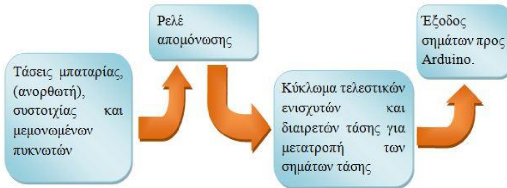
Εικόνα 5.8: Διάγραμμα ροής πλακέτας μετρήσεων
