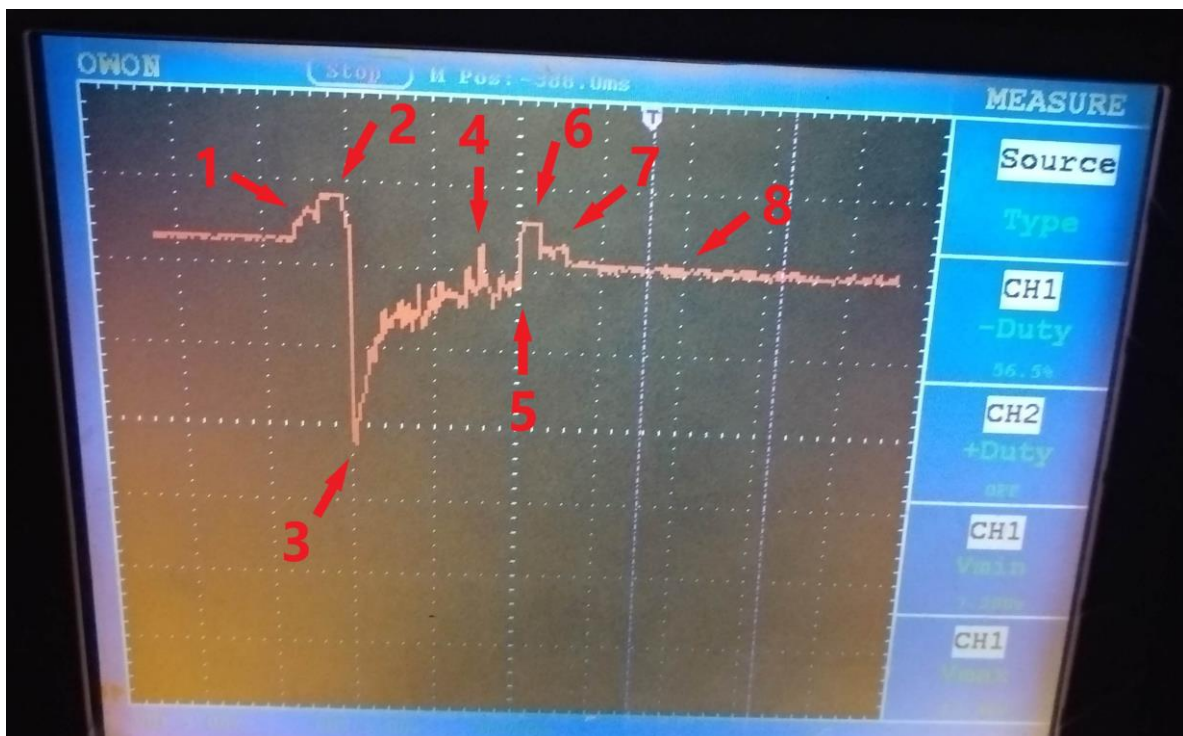
Εικόνα 7.2 : Κυματομορφή τάσης εκκίνησης με συστοιχία στα 13.65 Volt
