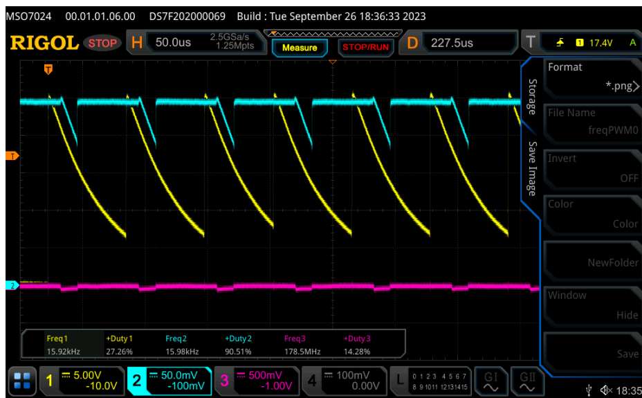
Εικόνα 35 Η συχνότητα της κάθε εξόδου του αντιστροφέα με τιμή 16 KHz.
