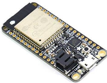
Εικόνα 5.7 Adafruit ESP32 Feather
