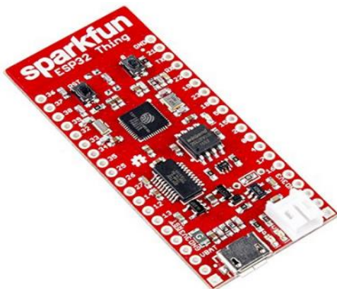
Εικόνα 5.8 Sparkfun ESP32 Thing
