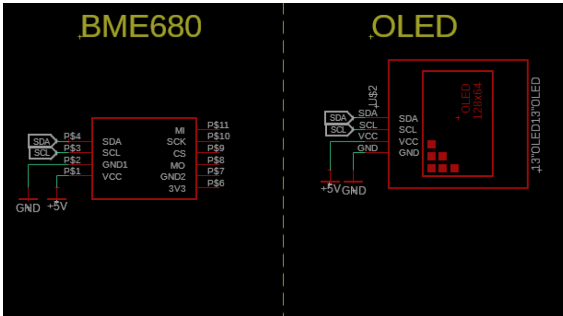
Σχήμα 4.6: Παράλληλη συνδεσμολογία του αισθητήρα BME680 και οθόνης OLED στον δίαυλο I2C.
