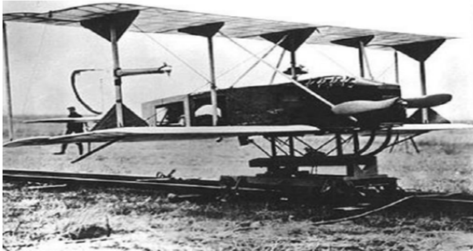
Σχήμα 1.2: Το Sperry Aerial Torpedo (1917), το οποίο αναγνωρίζεται ως μία από τις πρώτες πειραματικές υλοποιήσεις μη επανδρωμένου αεροχήματος σταθερού πτερυγίου, σχεδιασμένο αρχικά ως αυτόνομη εναέρια торπίλη [3].
