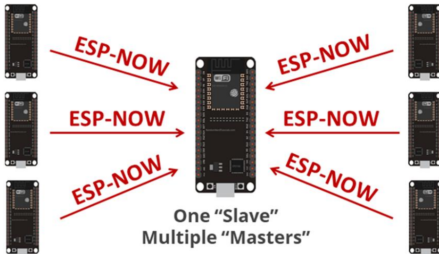
Εικόνα 3.2: Επικοινωνία των πομπών-ανιχνευτών με τον δέκτη
