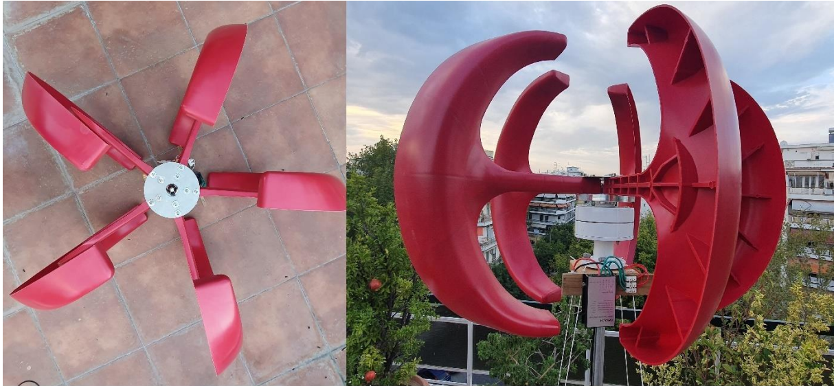
Σχήμα 4.7: Κάθετη και οριζόντια προβολή ανεμογεννήτριας με αεροτομές
