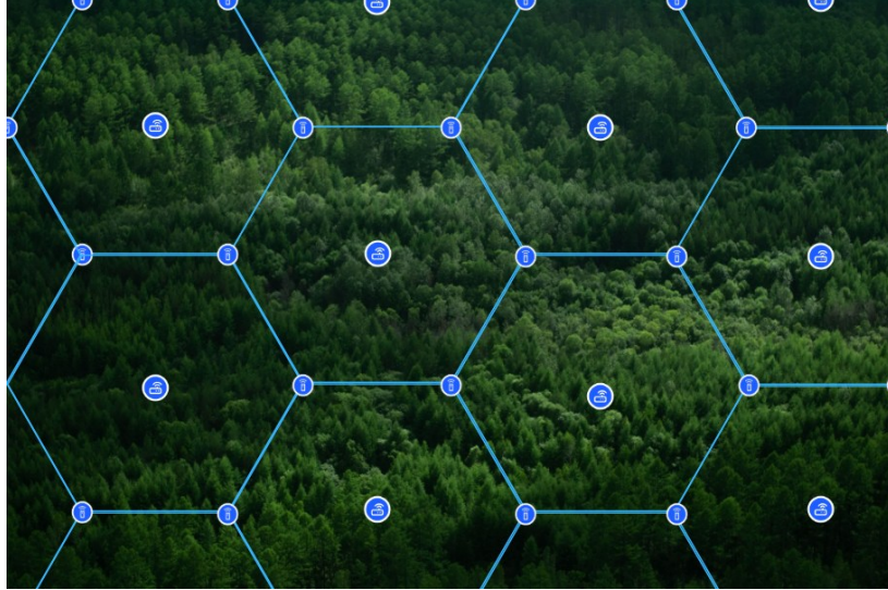
Σχήμα 4.2: Ενδεικτική διάταξη του ασύρματου δικτύου αισθητήρων με τους κόμβους LoRaWAN περιμετρικά της εξαγωνικής δομής και τις πύλες στα κέντρα των εξάγωνων
