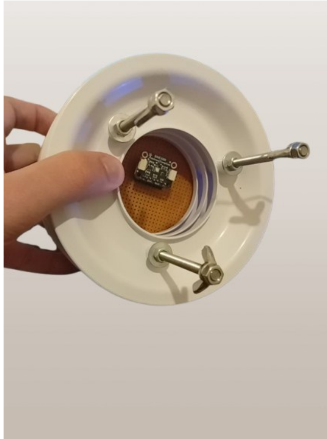
Σχήμα 5.11: Ο κλωβός τύπου Stevenson (κάτοψη).
