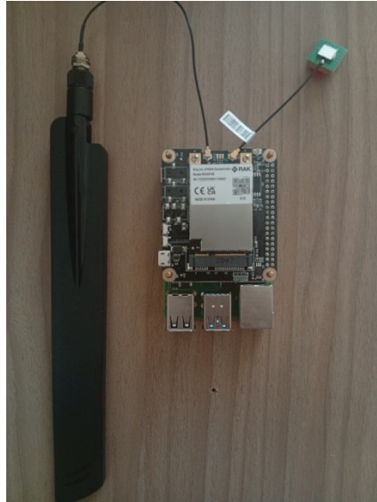
Σχήμα 5.18: Η πύλη LoRaWAN της παρούσας υλοποίησης αριστερά η LoRa κεραία και δεξιά αυτή για το GPS.
