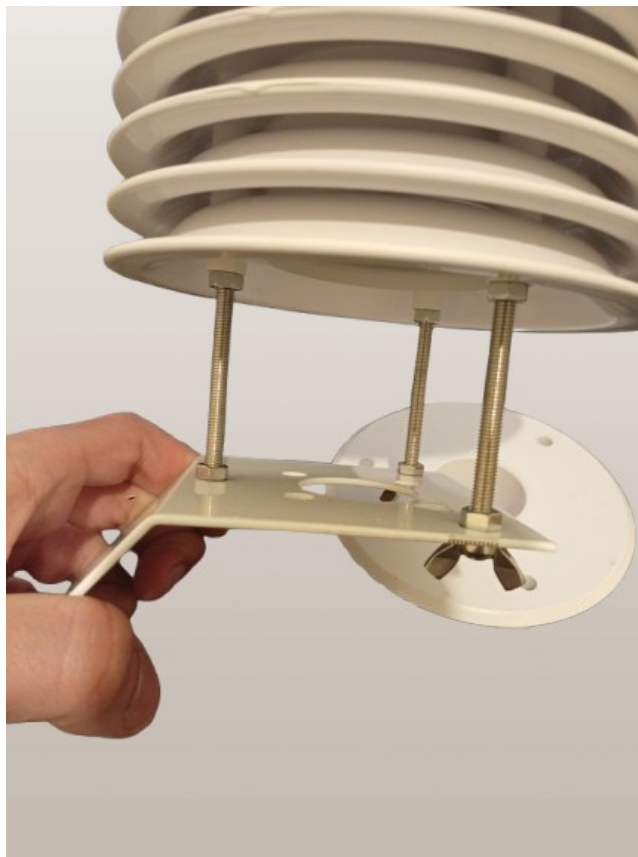
Σχήμα 5.10: Ο κλωβός τύπου Stevenson (όψη)
