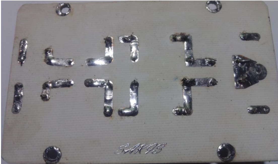
Εικόνα 1 : Τοπωμένο φίλτρο κάτω όψη
