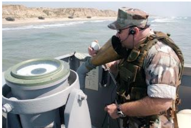
Εικόνα 1-2: «Σωλήνας φωνής» σε αποβατικό σκάφος του ναυτικού των Ηνωμένων Πολιτειών. Φωτογραφία από το 2005.
