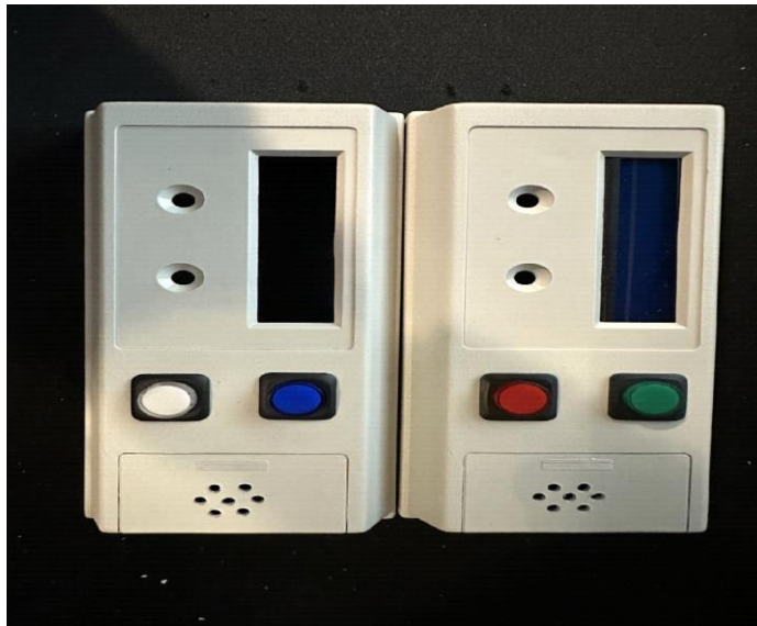
Εικόνα 3-7:Μπροσινή όψη της θήκης πομπού (αριστερά) και δέκτη (δεξιά) μαζί με αντίστοιχα μπουτόν.
