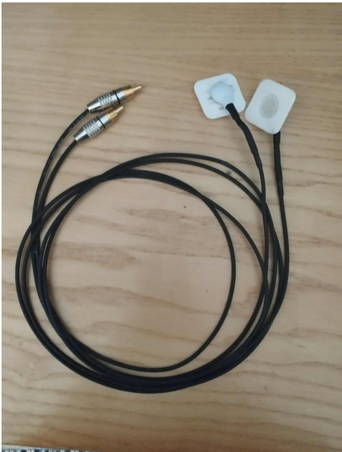
Σχήμα 2.10: Η τελική απεικόνιση των καλωδίων που κατασκευάστηκαν
