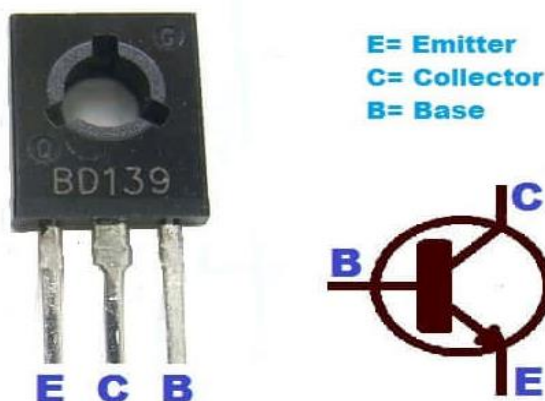
Σχήμα 4.2: Συσκευασία τρανζίστορ BD139 και το σύμβολο του διπολικού τρανζίστορ NPN, κατηγορία στη οποία ανήκει το συγκεκριμένο εξάρτημα. Πηγή: www.envirementalb.com
