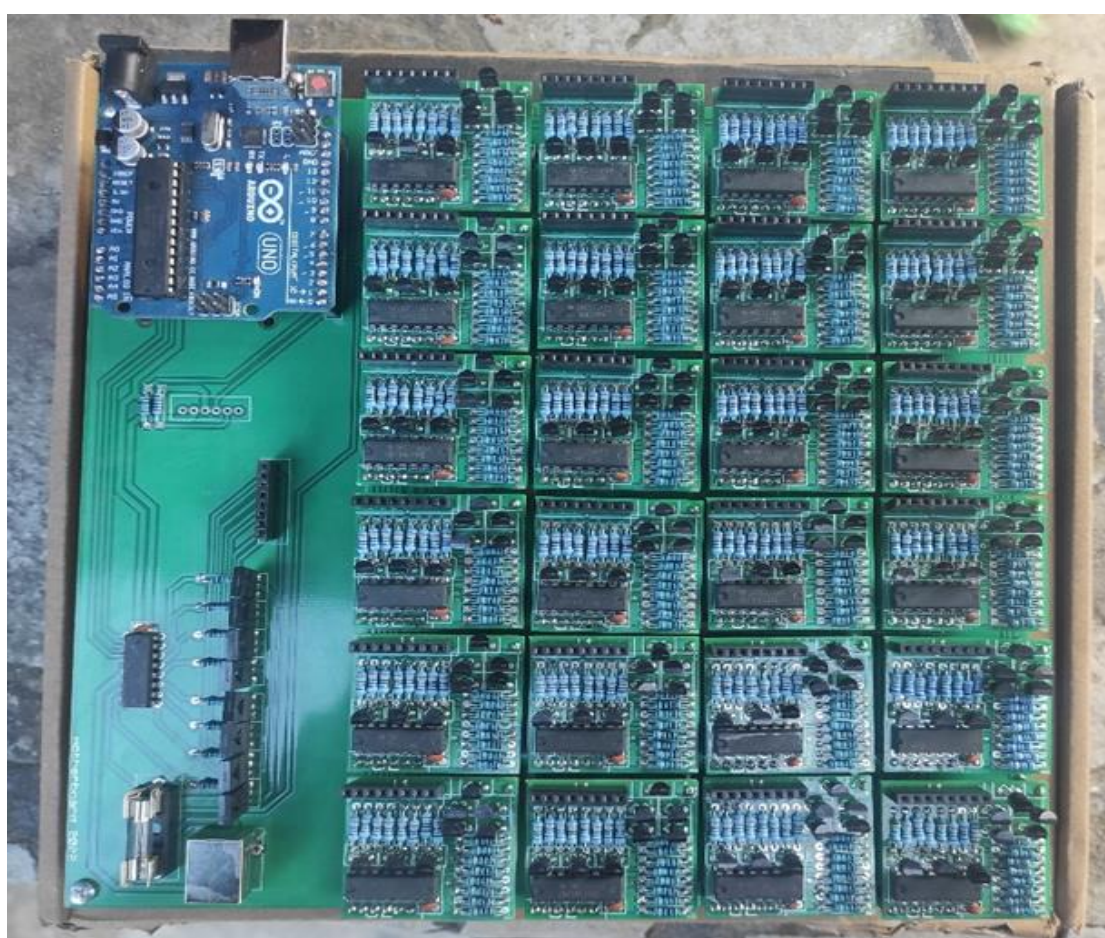
Σχήμα 4.28: Ολοκληρωμένο κύκλωμα οδήγησης αποτελούμενο από την κεντρική πλακέτα και είκοσι τέσσερις πλακέτες οδήγησης καθόδων.
