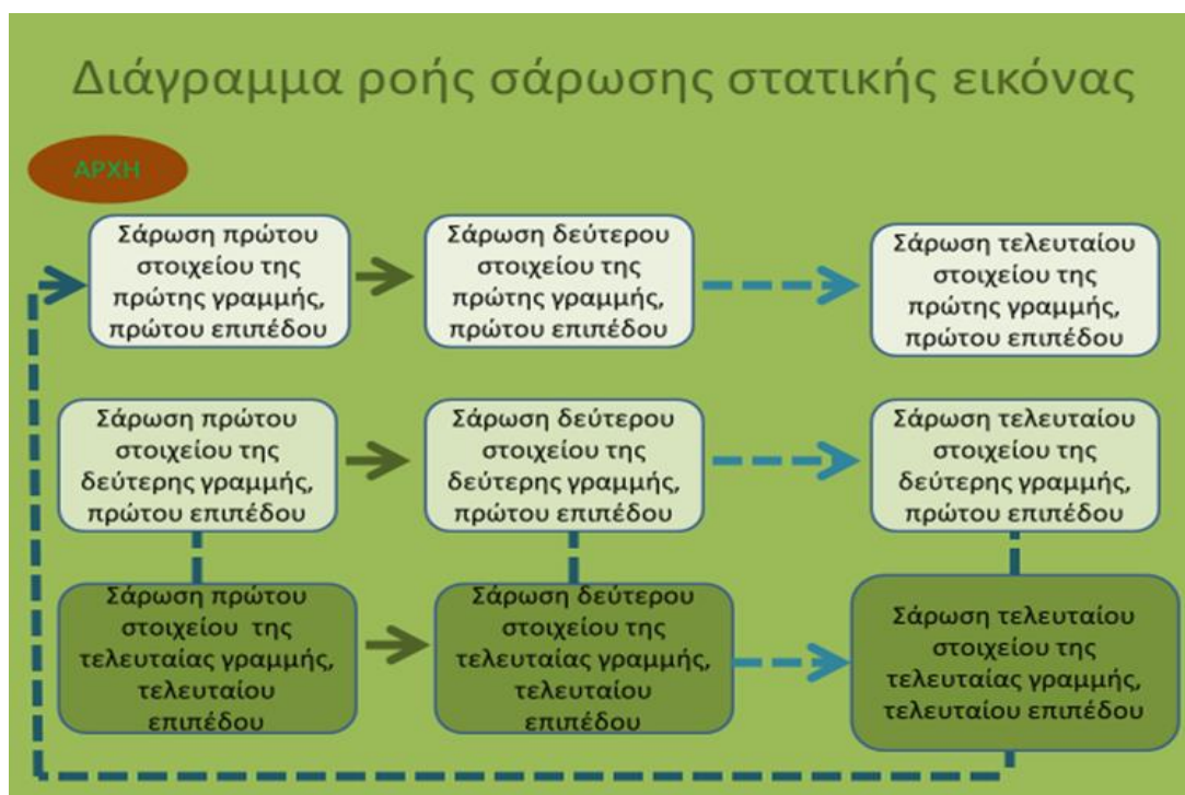
Σχήμα 5.2: Block Diagram της διαδικασίας σάρωσης.
