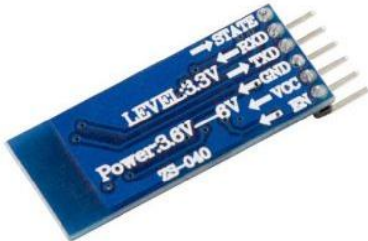
Σχήμα 4.8: Συνδεσμολογία των pin του Bluetooth Module HC-05. Πηγή: www.grobotronics.com
