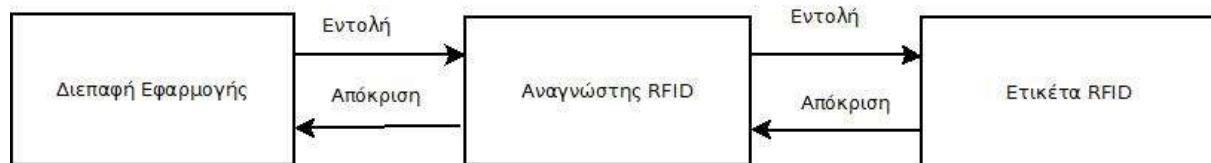
Σχήμα 1.4: Διάγραμμα ροής δεδομένων στο RFID
