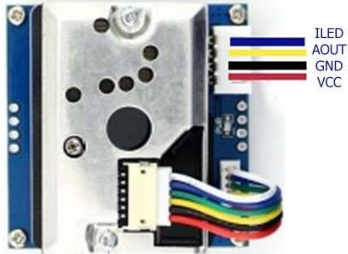
Σχήμα 2.4: Το διάγραμμα εξωτερικών συνδέσεων του αισθητήρα σκόνης
