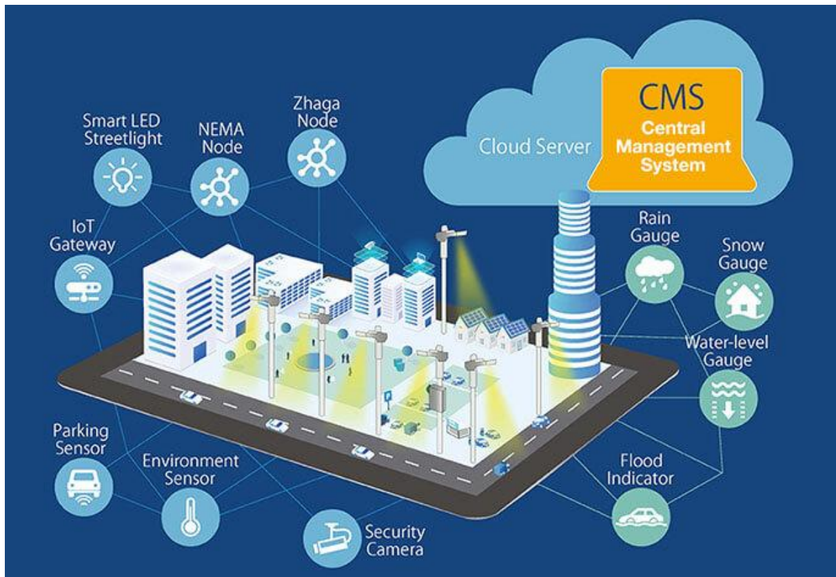
Εικόνα 5-2: Σύνδεση συστημάτων έξυπνου φωτισμού με άλλες υποδομές [64]
