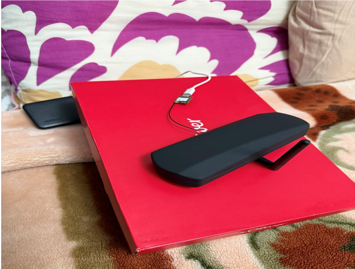
Εικόνα 4.6. Τοποθέτηση του Δέκτη στο χώρο της δοκιμής εμβέλειας στα 14 μέτρα, απόσταση από τον Πομπό (LoS).
