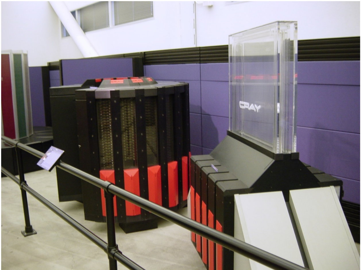
Σχήμα 1.1 Ο Cray-2 και στα δεξιά του ο σταθμός ψύξης του σε σχήμα καταρράκτη
