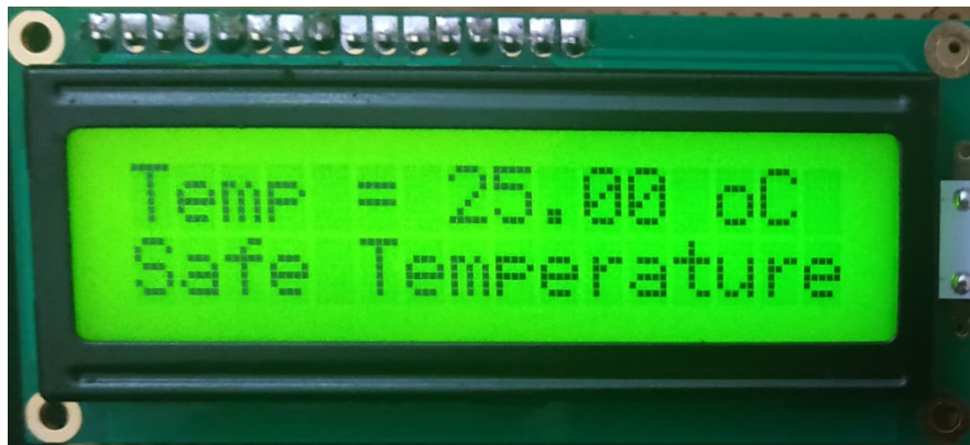
Σχήμα 5.2 Η οθόνη LCD και η ενημέρωση που παρέχει στον χρήστη
