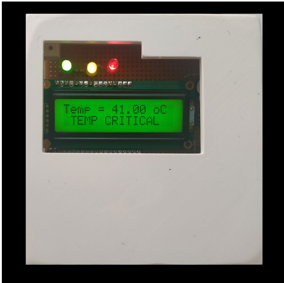
Σχήμα 4.7 Φωτογραφία του τελικού κυκλώματος μετά την προσθήκη του καλύμματος
