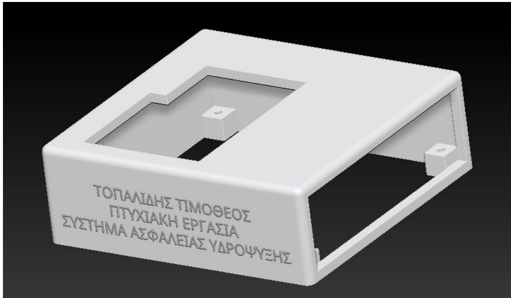
Σχήμα 4.6 Τελική σχεδίαση καλύμματος με το πρόγραμμα ZBrush
