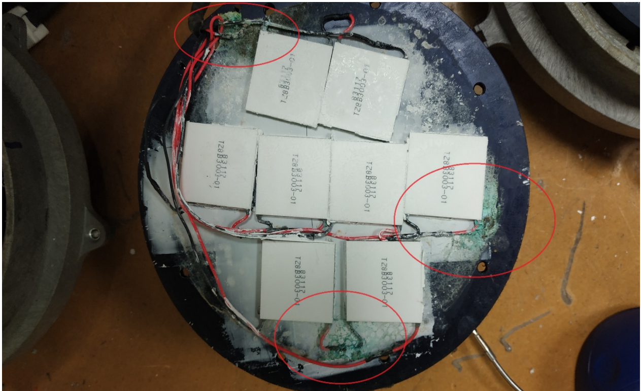
Σχήμα 2.8 Χαρακτηριστικό παράδειγμα ψυγείου της εταιρείας με χαλασμένα Peltier λόγω ανάπτυξης υγρασίας
