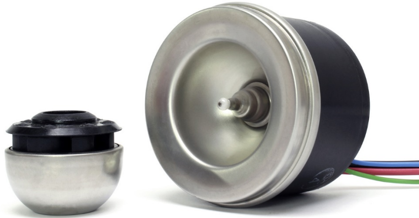
Σχήμα 1.17 Αντλία D5 σε τυπικό κυλινδρικό σχήμα και στα αριστερά της η προπέλλα που ωθεί το υγρό και τις DDC με Flow Rate στα 1000 λίτρα την ώρα και Head Pressure Rating από 5 έως και 7 μέτρα.
