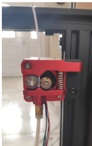
Εικόνα 3.6. Ο μηχανισμός εξώθησης του νήματος πριν εισέλθει στο σωληνάκι PTFE
