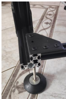
Εικόνα 3.1. Οι συνδέσεις των εξαρτημάτων σε μία από τις τέσσερις γωνίες του πλαισίου
