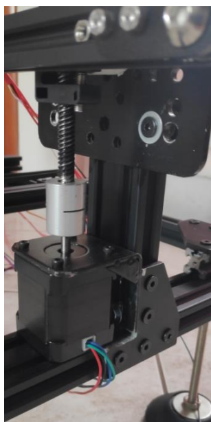
Εικόνα 3.3. Η σύνδεση των εξαρτημάτων για την κίνηση στον άξονα Z
