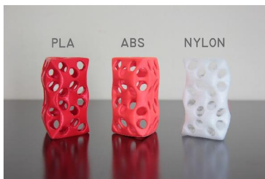
Εικόνα 2.30. Οι διαφορές ανάμεσα σε PLA, ABS και Nylon
