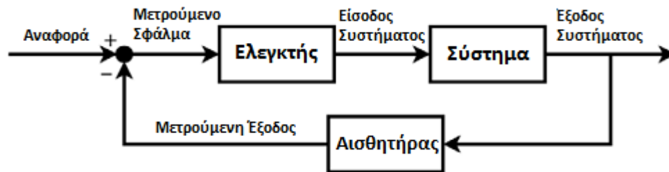
Σχήμα 3.3: Μπλοκ – διάγραμμα διεργασίας με αρνητική ανάδραση [7]
