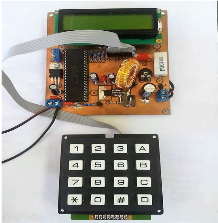
Σχήμα 4.19: Τελική διάταξη παλμοτροφοδοτικού
