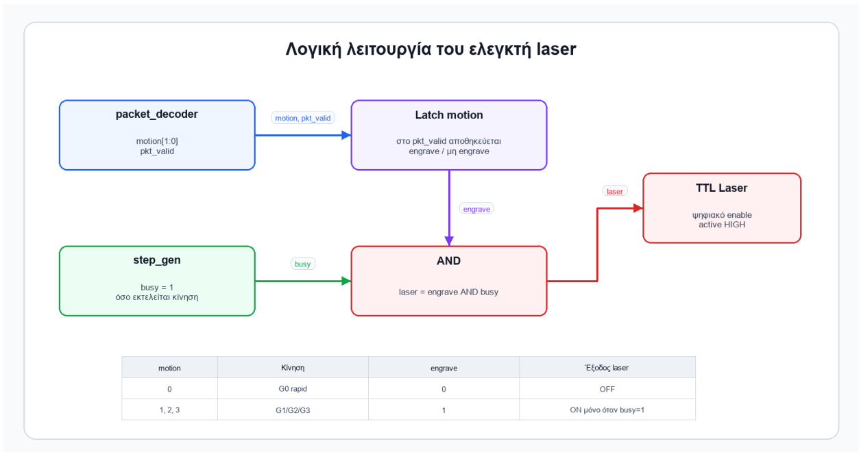
Σχήμα 5.9: Λογική λειτουργία της μονάδας laser_ctrl.
