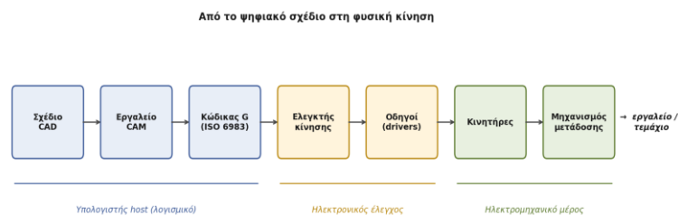
Σχήμα 2.1: Αλυσίδα μετάδοσης πληροφορίας από το ψηφιακό σχέδιο έως τη φυσική κίνηση της κεφαλής.
