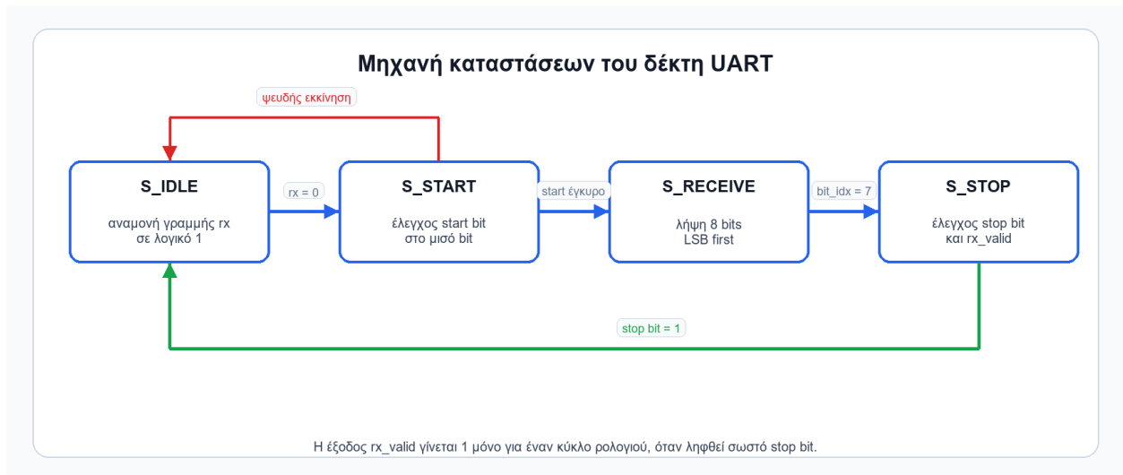
Σχήμα 5.2: Μηχανή καταστάσεων του δέκτη UART.
