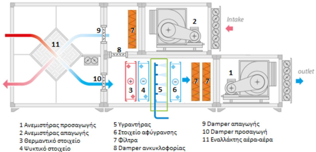
Εικόνα 13. Μονάδα διαχείρισης αέρα (AHU)
