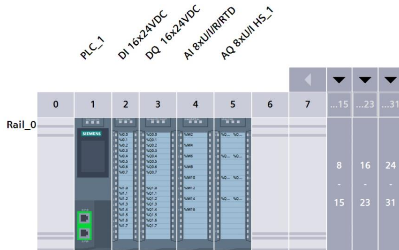
Εικόνα 39. Hardware configuration of PLC system
