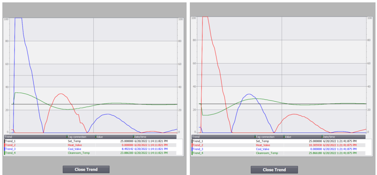
Εικόνα 69. Απόκριση του συστήματος θέρμανσης – ψύξης στις μεταβολές της θερμοκρασίας περιβάλλοντος.
