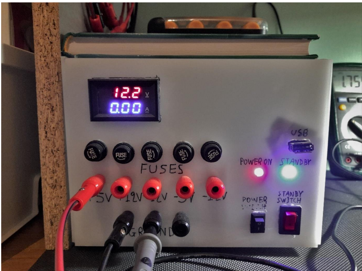
Σχήμα 5.26 Μονάδα Τροφοδοσίας Πειράματος
