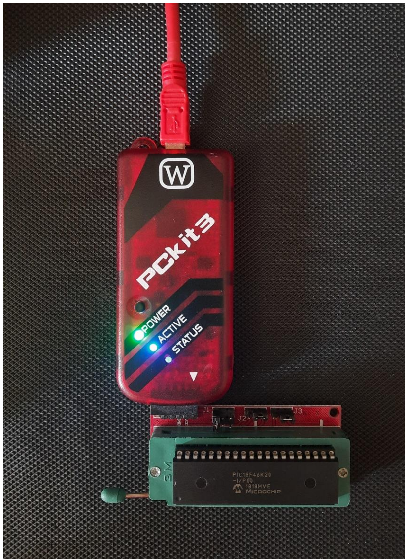
Σχήμα 5.16 Προγραμματιστής PICkit3 Φορτώνει το Κώδικα στον Μικροελεγκτή
