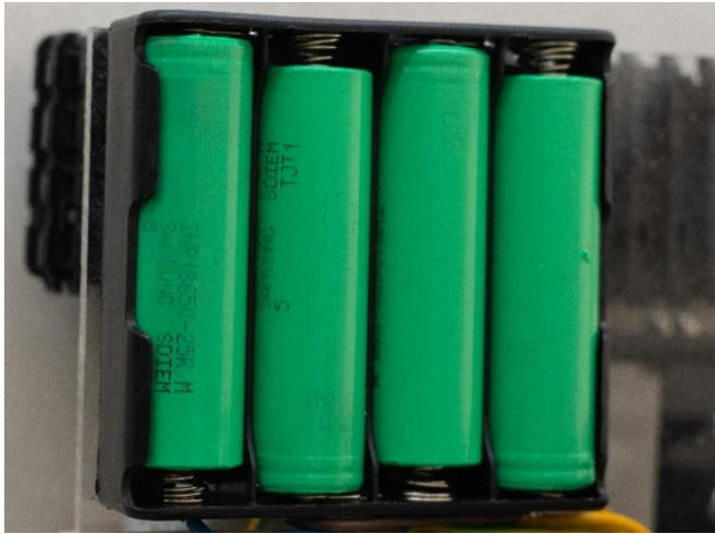
Σχήμα 5.35 Σύστημα Τροφοδοσίας Crobarm από Μπαταρίες
