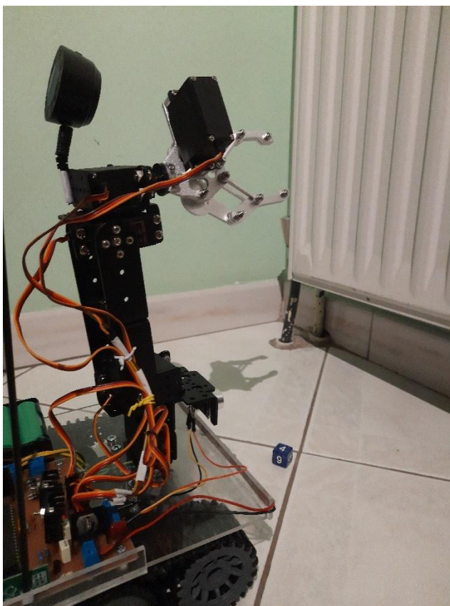
Σχήμα 5.52 Λειτουργία Βραχίονα/Τανκ για Μεταφορά ενός Ζαριού από Σημείο Α σε Σημείο Β – 4
