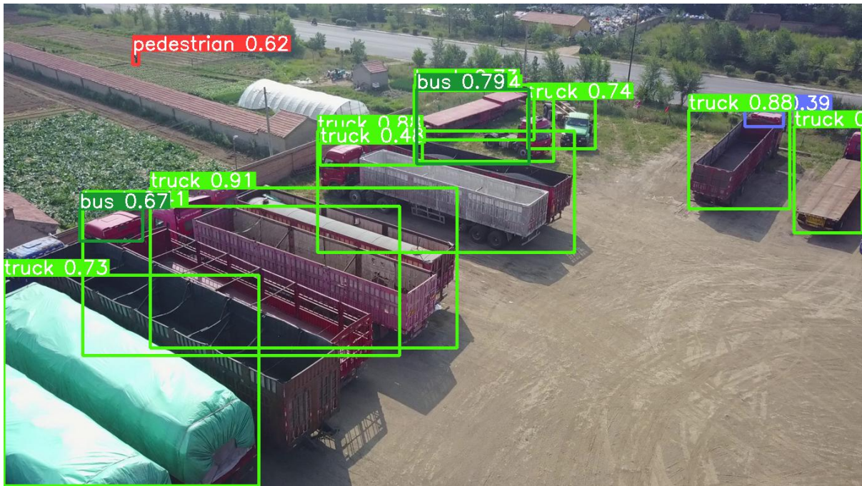
Εικόνα 5.8: Παράδειγμα πρόβλεψης με τη χρήση SAHI (α)
