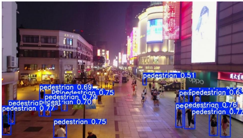
Εικόνα 5.4: Παράδειγμα πρόβλεψης χωρίς τη χρήση SAHI (β)
