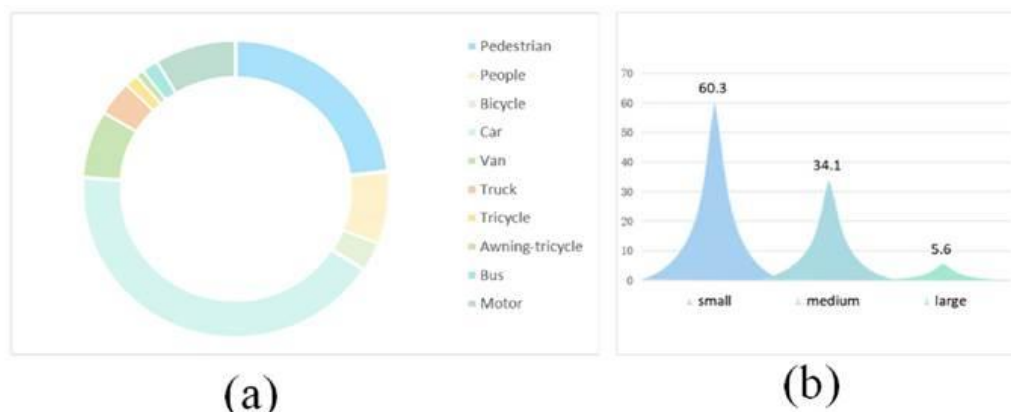
Εικόνα 3.12: Στατιστικά του συνόλου δεδομένων VisDrone. (a) Το ποσοστιαίο μέγεθος της κάθε κατηγορίας αντικειμένων, (b) Η κατανομή των αντικειμένων στις κλίμακες μικρό < 20x20 pixels (small), μεσαίο 20 – 32 pixels (medium), μεγάλο > 32x32 pixels (big) [38].
