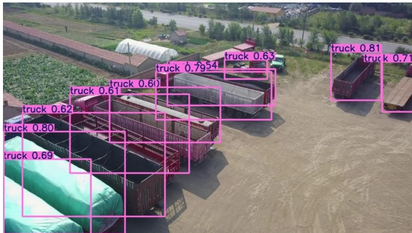
Εικόνα 5.3: Παράδειγμα πρόβλεψης χωρίς τη χρήση SAHI (α)
