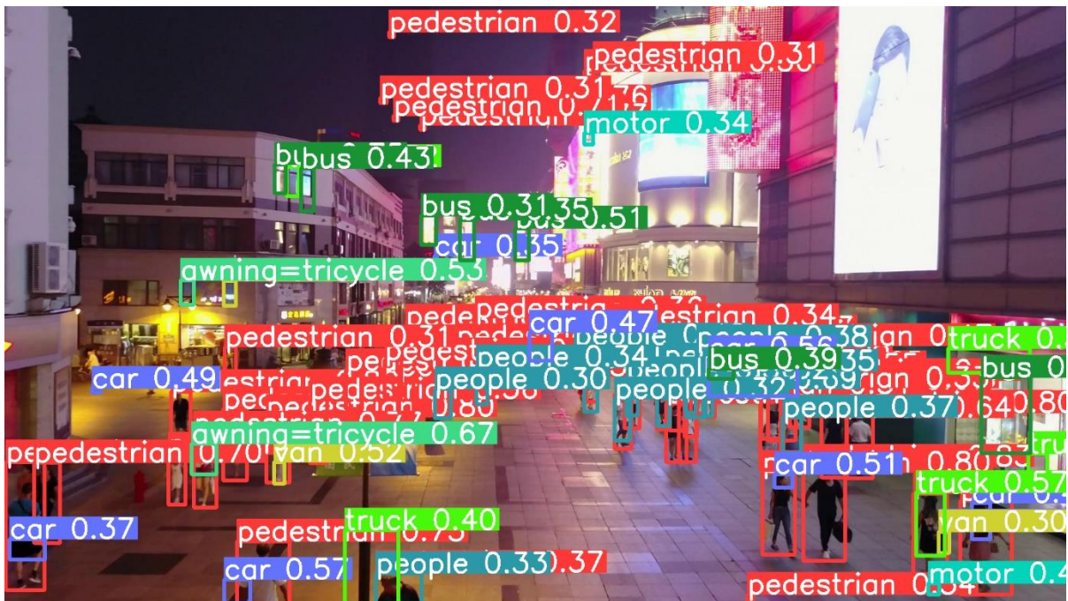
Εικόνα 5.9: Παράδειγμα πρόβλεψης με τη χρήση SAHI (β)
