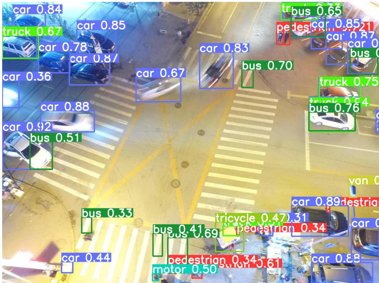
Εικόνα 5.12: Παράδειγμα πρόβλεψης με τη χρήση SAHI (ε)
