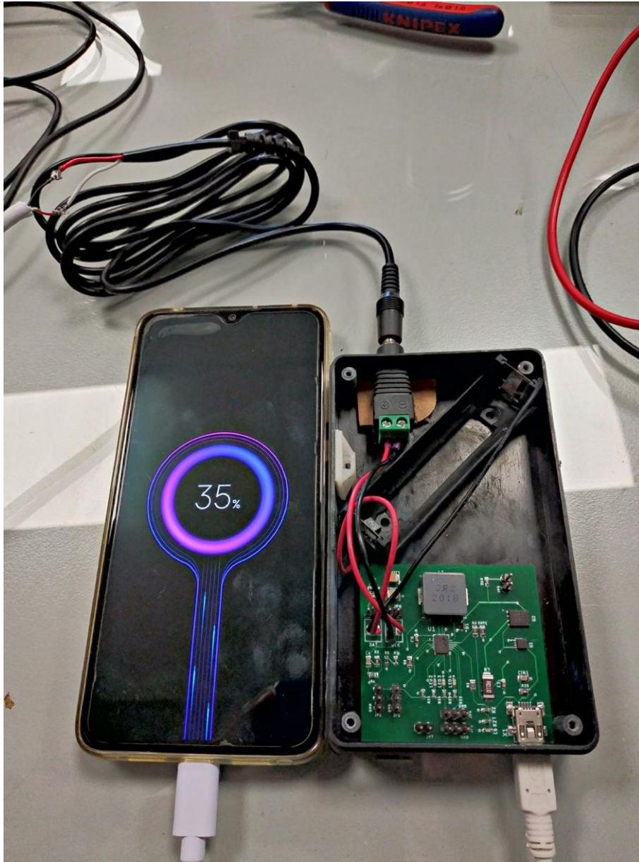
Σχήμα 2.12 Συνδέουμε το κινητό στην έξοδο του τροφοδοτικού. Χωρίς τη μπαταρία, μόνο με το βασικό σύστημα τροφοδοσίας φορτίζει το κινητό.
