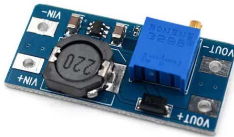
Σχήμα 4.5: DC-DC Μετατροπέας ανύψωσης τάσης
