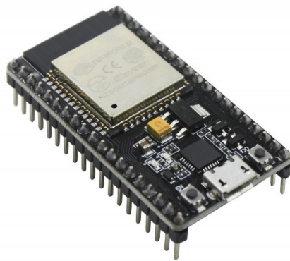
Σχήμα 3.2: Μικροελεγκτής ESP32 (Πηγή: https://tinyurl.com/684fat2e )
