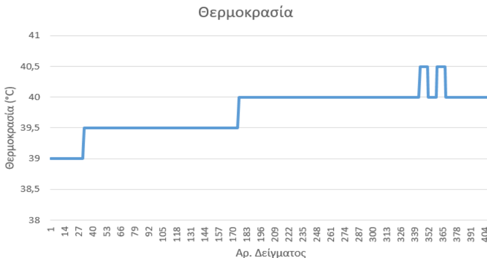
Σχήμα 5.17: Θερμοκρασία δύο πλαισίων σε σειρά χωρίς σκίαση
