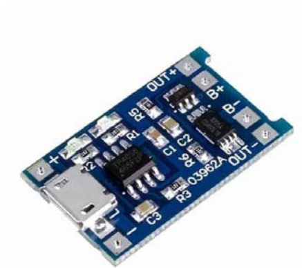
Σχήμα 4.6: Πλακέτα φόρτισης και προστασίας μπαταρίας ιόντων λιθίου
