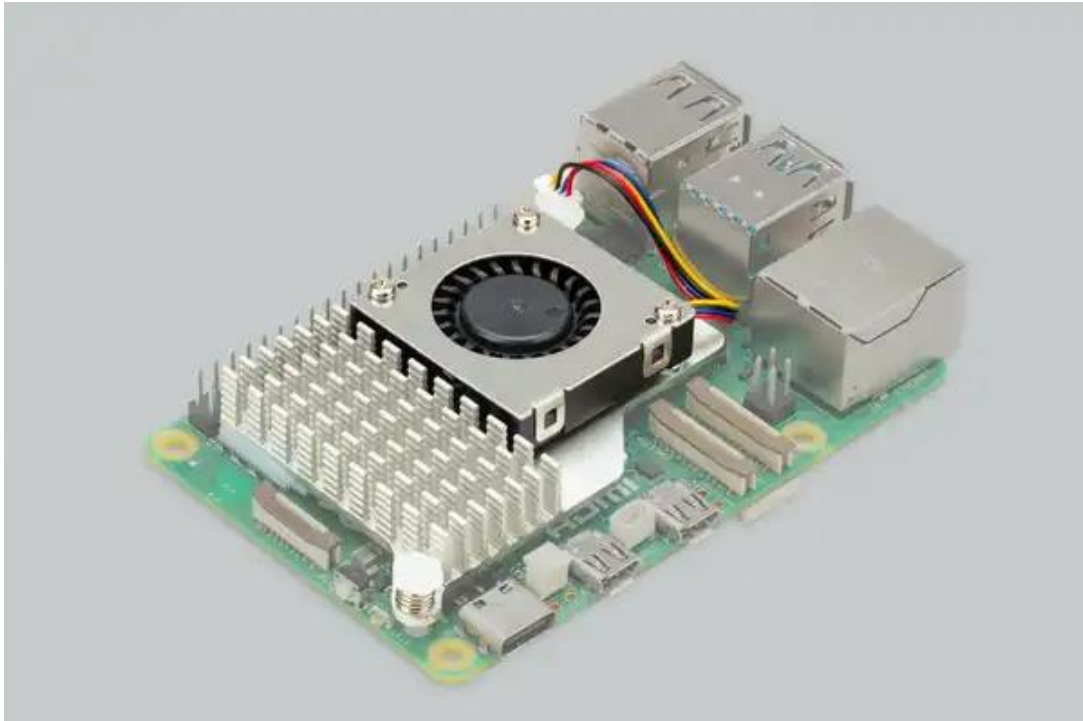
Σχήμα 3.2: Τοποθέτηση ψύκτρας και heatsink στο board [9].
