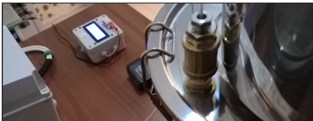
Εικόνα 34: Η τοποθέτηση του αισθητήρα PT100 στο καπάκι του λέβητα.
