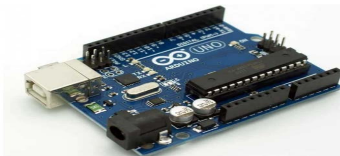
Σχήμα 6.7: Η αναπτυξιακή πλακέτα ARDUINO UNO
