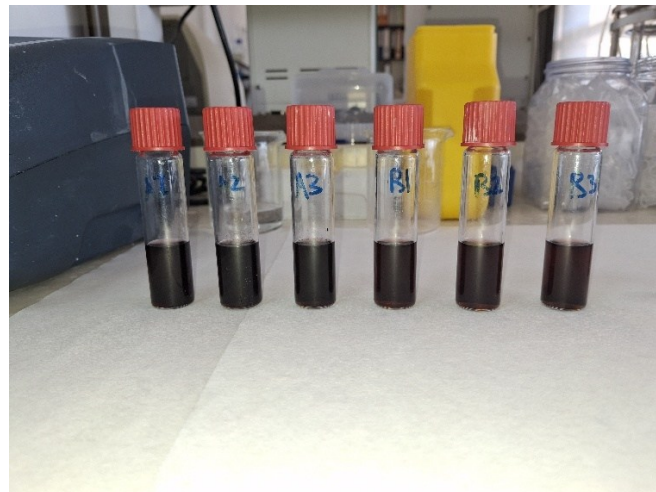
Σχήμα 5.16 Πρότυπες συγκεντρώσεις λιπιδίων (ελαϊκό οξύ ή παρόμοιο) σε αυξανόμενες ποσότητες
