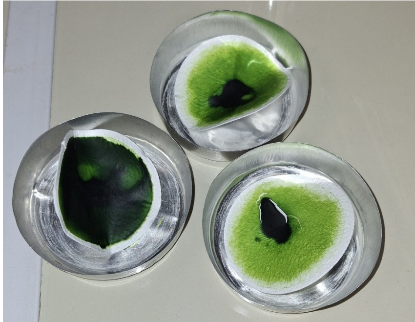
Σχήμα 5.9 Διήθηση για εξαγωγή βιομάζας και προσδιορισμό ξηρού βάρους
