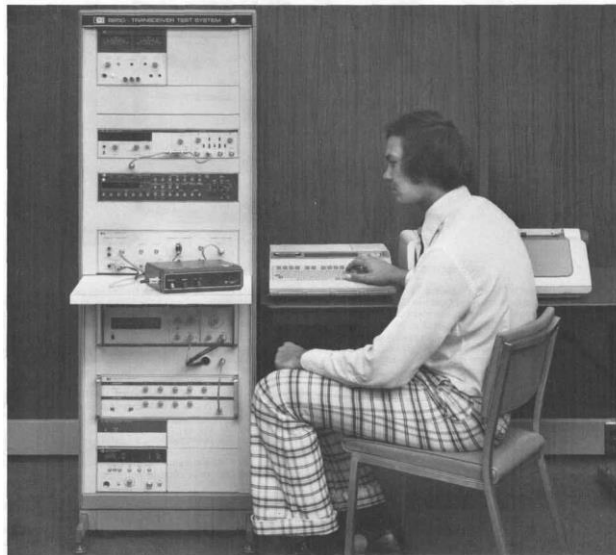
Εικόνα 2-5 Rack and stack με μετρητικά όργανα συνδεδεμένα μέσω GPIB [36]
