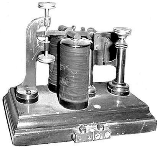
Εικόνα 1-2 Πρώτο βιομηχανικό ρελέ [22]
