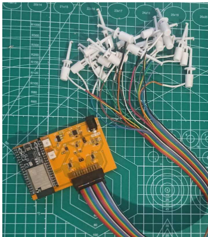
Εικόνα 5-11 Ολοκληρωμένη προγραμματιζόμενη συσκευή ελέγχου ηλεκτρονικών κυκλωμάτων
