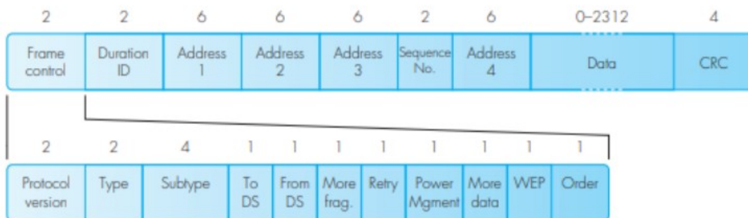
Εικόνα 4.1: Τυποποιημένη μορφή πλαισίου IEEE 802.11. [30]
