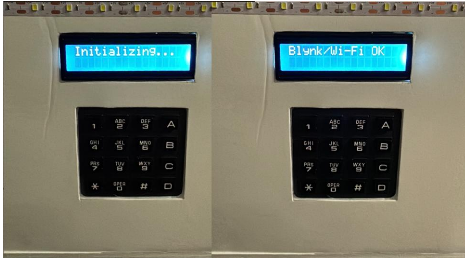
Σχήμα 6.2: Αρχικοποίηση συστήματος και έλεγχος Wi-Fi
