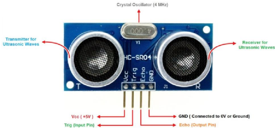
Σχήμα 5.17: Αισθητήρας υπερήχων HC-SR04
