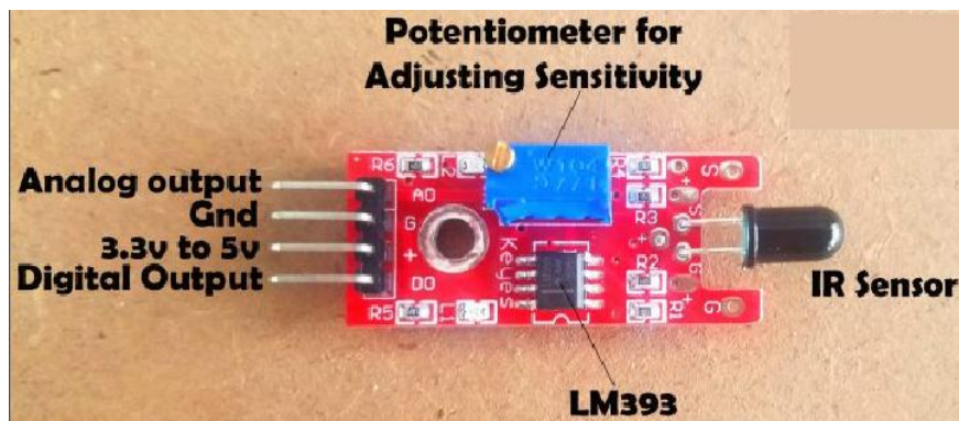
Σχήμα 5.11: Ανιχνευτής φωτιάς KY-026
