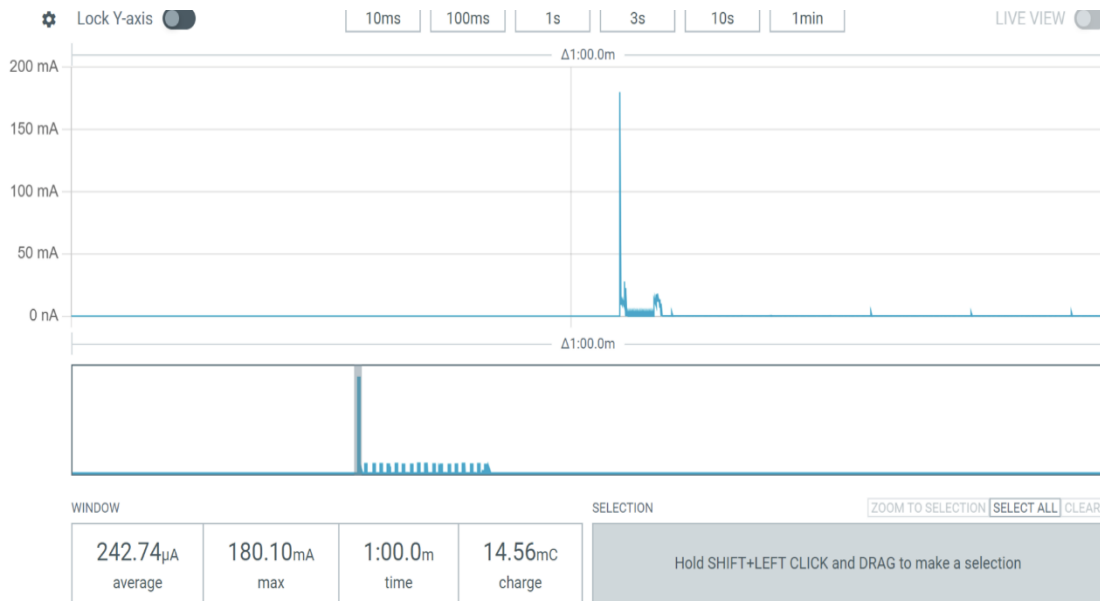
Εικόνα 5.14: Κατάσταση εκκίνησης μικροελεγκτή από απώλεια τροφοδοσίας
