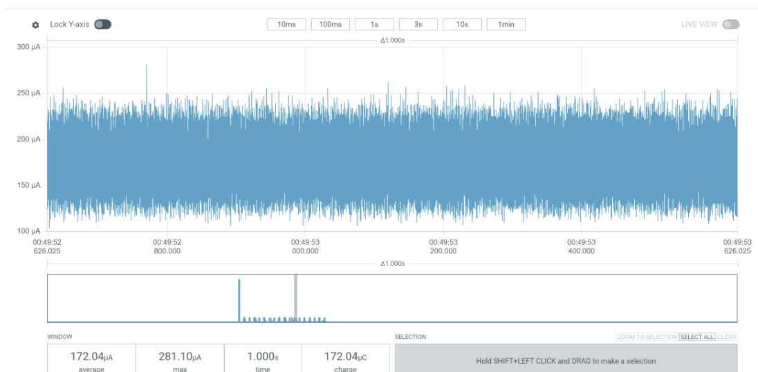
Εικόνα 5.15 : κατάσταση χαμηλής κατανάλωσης MCU
