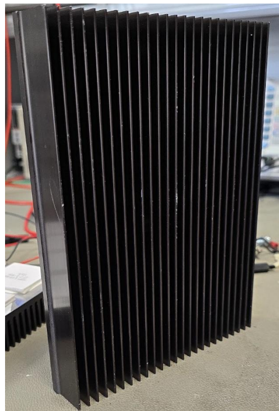
Εικόνα 4.14 : Κατασκευή ψύκτρας από το μηχανουργείο πάνω πλευρά
