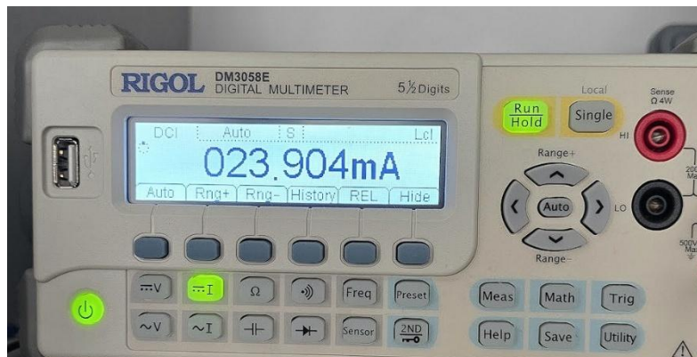
Εικόνα 5.9: Μέτρηση μέγιστου ρεύματος
