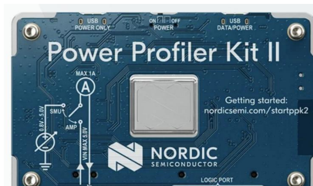
Εικόνα 4.37 : Μετρητής κατανάλωσης κυκλωμάτων
