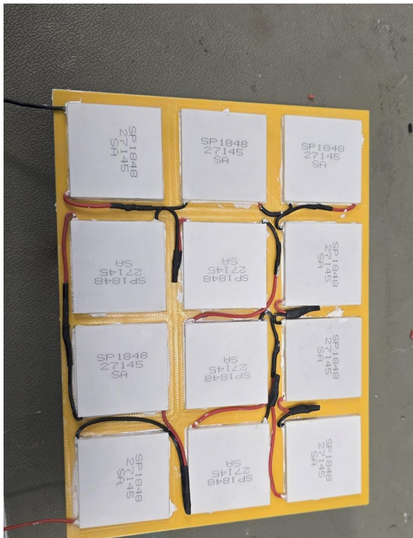
Εικόνα 4.26 : Τοποθέτηση των Peltier στην μήτρα υποδοχής
