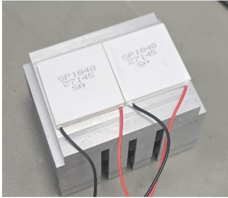
Εικόνα 4.1 : Peltier module σε σειρά
