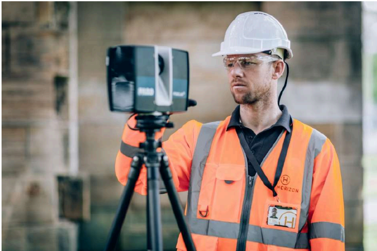
Εικόνα 2.1 : 1ST HORIZON 3D Τοπογράφος με σαρωτή λέιζερ [44]
