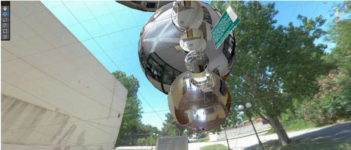
Εικόνα 5.5.5 : Οι σφαίρες που χρησιμοποιούν Skybox Shader φαίνεται να επικαλύπτονται λανθασμένα μεταξύ τους κατά το render
