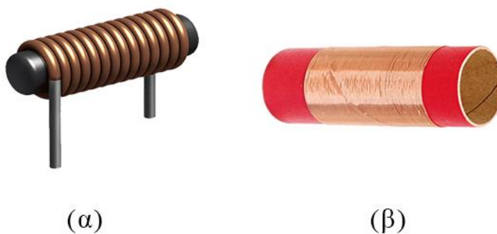
Σχήμα 1.6 α) Πηνίο με πυρήνα β) Πηνίο χωρίς πυρήνα
