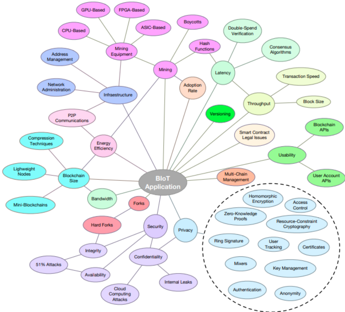
Σχήμα 3-5. Οι περισσότεροι σχετικοί παράγοντες που καθορίζουν την ανάπτυξη μιας εφαρμογής ΒΙοΤ και οι κύριες σχέσεις τους. Πηγή: (Fernández-Caramés & Fraga-Lamas, 2018).
