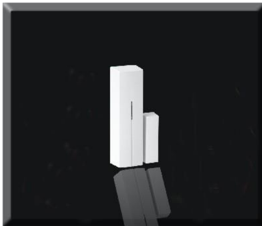
18 Σχήμα 7.7: Μαγνητικό αισθητήριο σε σύστημα ασφαλείας
