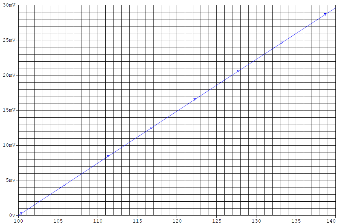
Διάγραμμα 4.4: Διαφορική τάση γέφυρας συναρτήσει της αντίστασης Pt100
