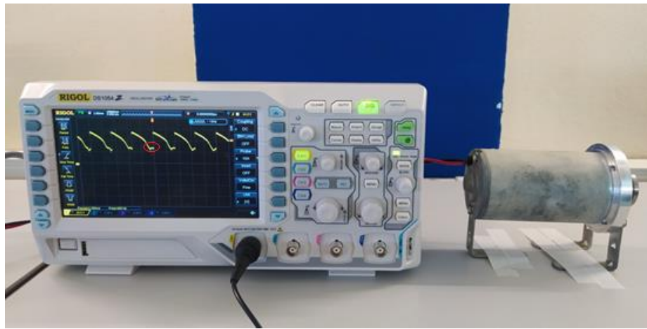
Σχήμα 5.9 Κυματομορφή εξόδου με καθυστέρηση φάσης 40^\circ
