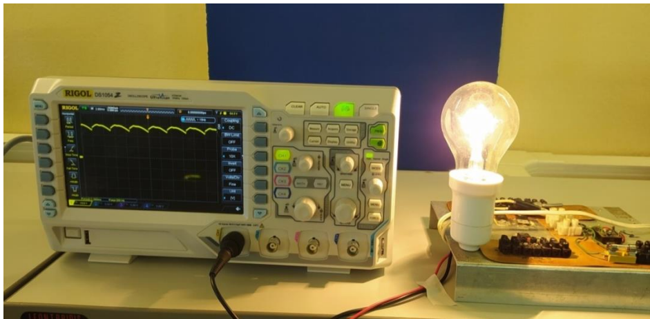
Σχήμα 5.21 Κυματομορφή εξόδου με καθυστέρηση φάσης 0^\circ
