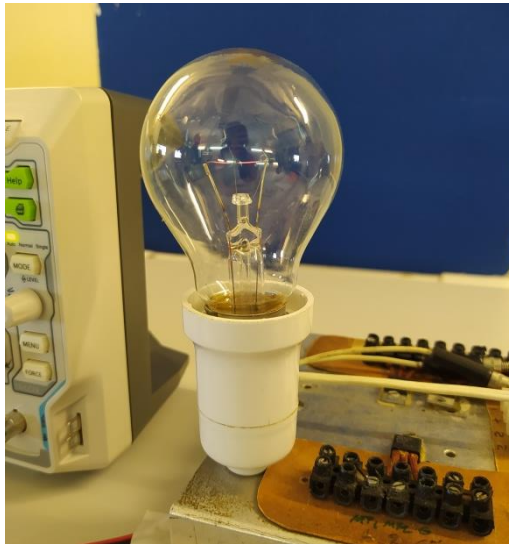
Σχήμα 5.12-5.13 Κυματομορφή εξόδου και φωτεινότητα λαμπτήρα με καθυστέρηση φάσης 80^\circ
