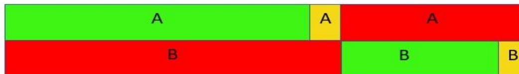
Εικόνα 2.5. Χρονική απεικόνιση κύκλου φαναριών σε κατάσταση ( POH_A > POH_B ).
