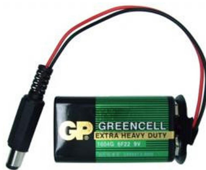
Εικόνα 4.3. 9 Volt μπαταρία σε 2.1 x 5.5 mm αρσενικό.
