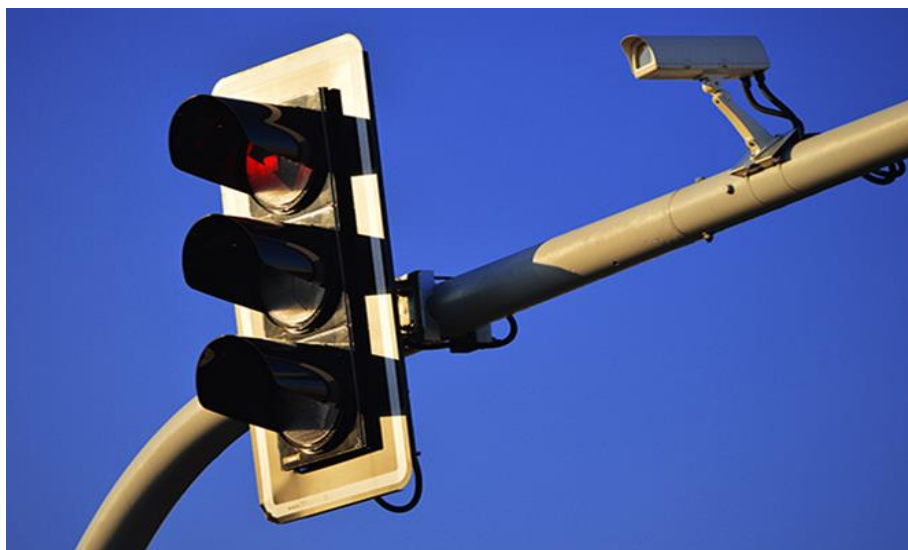
Εικόνα 1.14: Σύστημα ανίχνευσης και παρακολούθησης με ψηφιακή επεξεργασία εικόνας.
