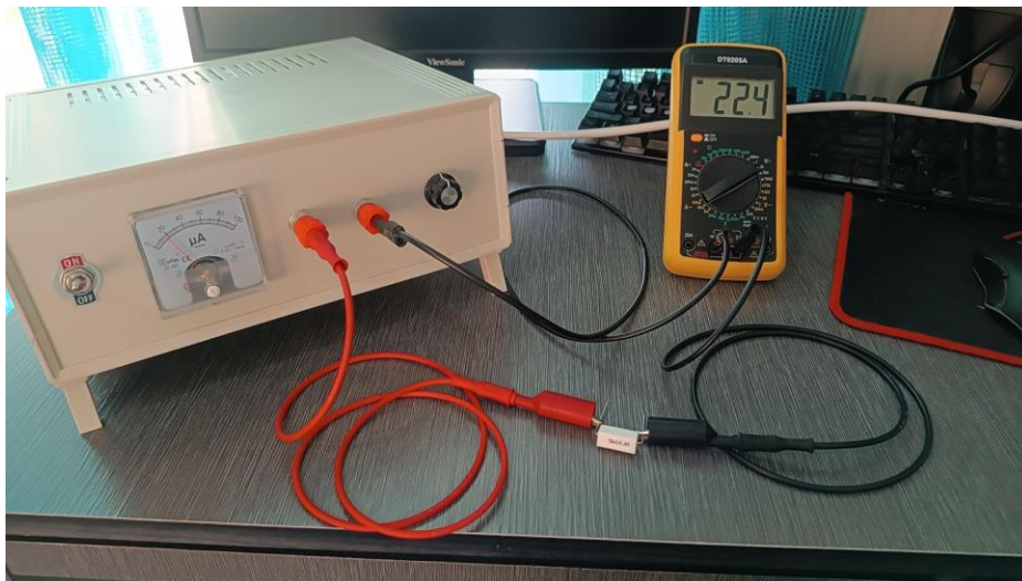
Σχήμα 7.9 : Δοκιμή λειτουργίας του τροφοδοτικού με σύνδεση αντίστασης φορτίου 5W/1kΩ
