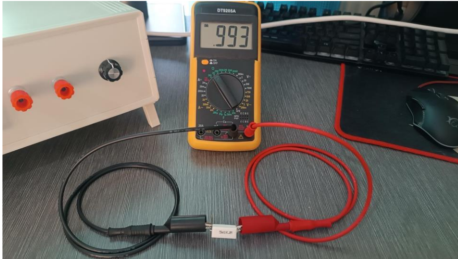
Σχήμα 7.10 : Μέτρηση της αντίστασης φορτίου με χρήση ψηφιακού πολύμετρου.
