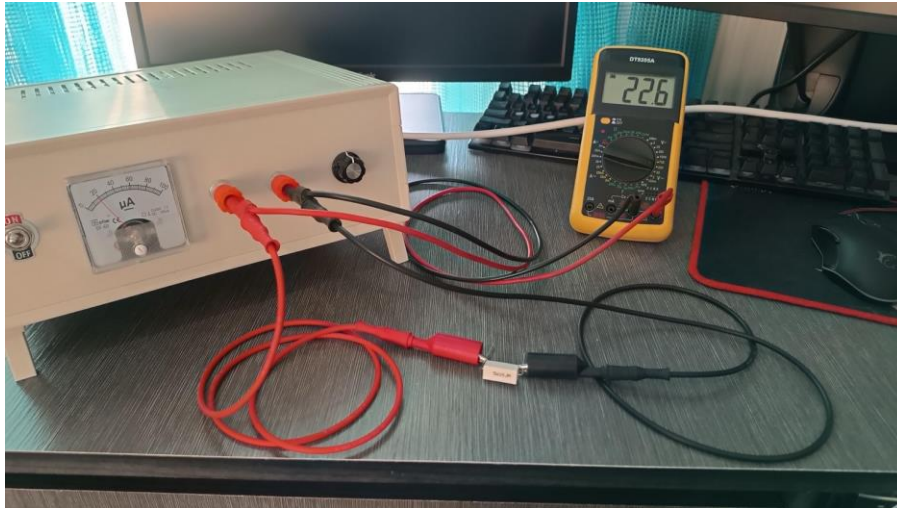
Σχήμα 7.8 : Μέτρηση της τάσης εξόδου του ρυθμιζόμενου τροφοδοτικού με χρήση ψηφιακού πολύμετρου.
