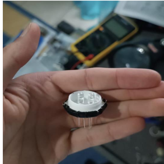
Σχήμα 7.5 : κατασκευή του οπτοζεύκτη με χρήση LED, φωτοαντίστασης και πλαστικού περιβλήματος για απομόνωση από τον εξωτερικό φωτισμό.
