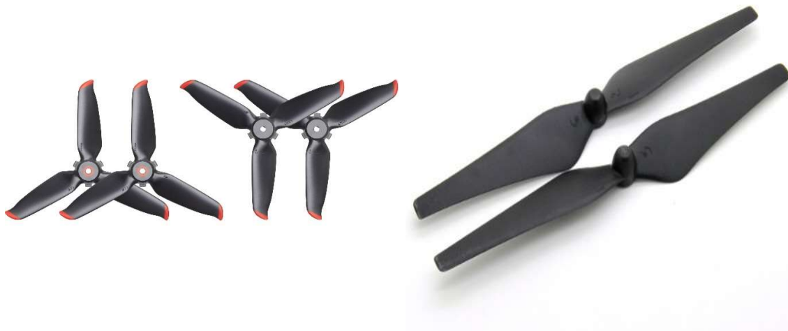
Εικόνα 16: Έλικες με τρία και έλικες με 2 πτερύγια.
