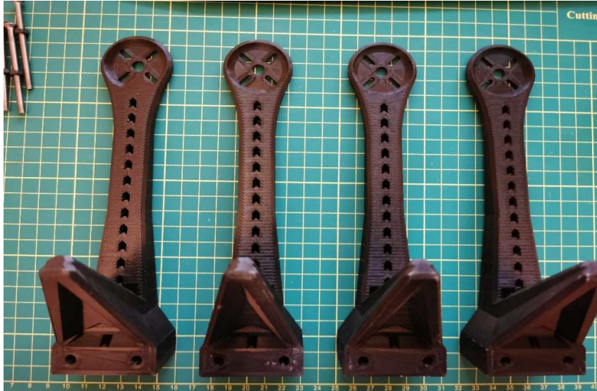
Εικόνα 41: Οι 4 βραχίονες πάνω στους οποίους θα σταθεροποιηθούν με βίδες τα μοτέρ. Κάθε βραχίονας έχει μήκος 20 cm και βάρος 90 gr.
