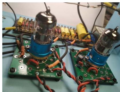
Εικόνα 53. Οι λυχνίες του ενισχυτή τοποθετημένες στις πλακέτες τους.
