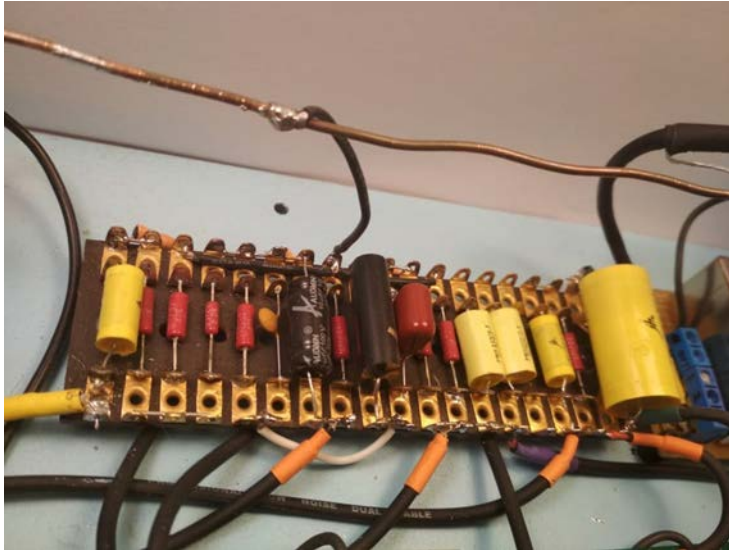
Εικόνα 49. Ο ενισχυτής σε tag board.
