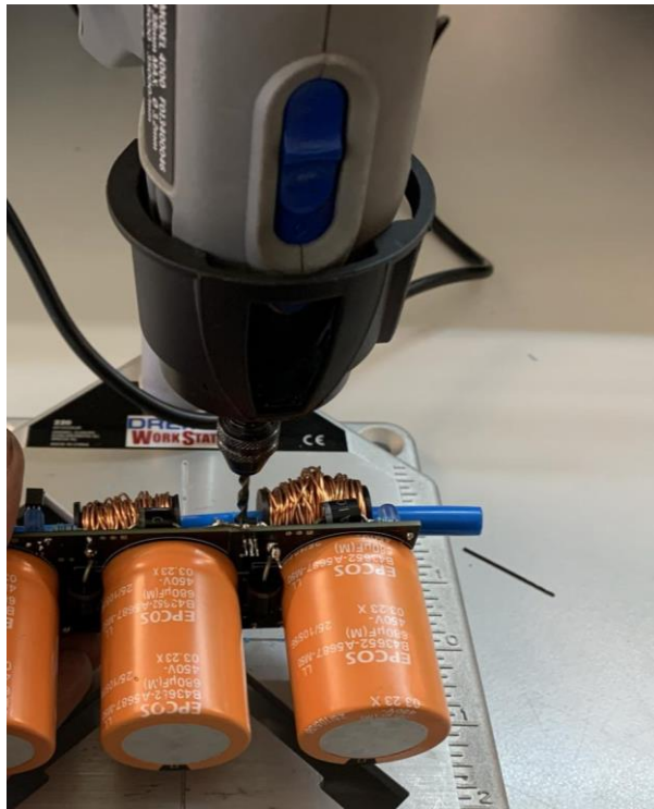
Σχήμα 5.18. Διάτρηση ανοιγμάτων στον σωλήνα του EMA.
