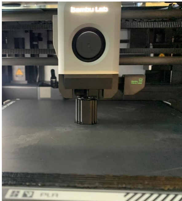
Σχήμα 5.15. Αριστερά: Η εκτύπωση από το καρούλι που τυλίγεται το πηνίο με χρήση 3D εκτυπωτή. Δεξιά: Το εκτυπωμένο καρούλι με την χρήση 3D εκτυπωτή για τη δημιουργία των πηνίων.
