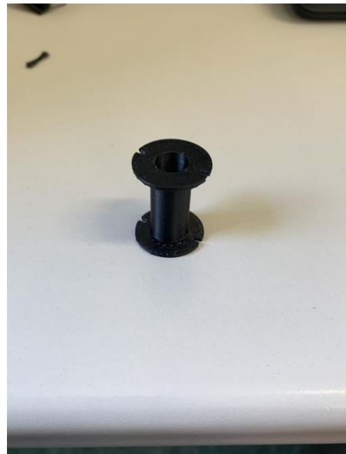
Σχήμα 5.15. Αριστερά: Η εκτύπωση από το καρούλι που τυλίγεται το πηνίο με χρήση 3D εκτυπωτή. Δεξιά: Το εκτυπωμένο καρούλι με την χρήση 3D εκτυπωτή για τη δημιουργία των πηνίων.
