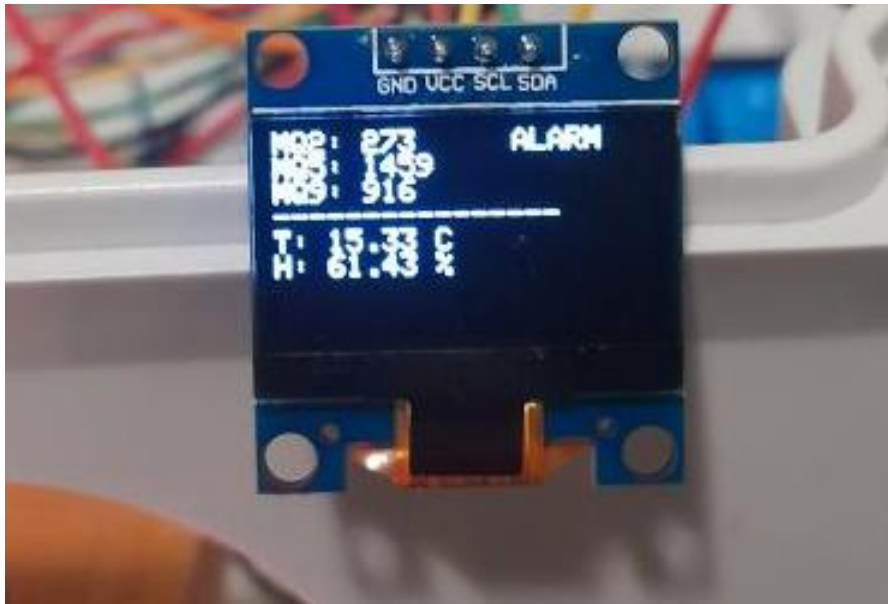
Εικόνα 4.5 Ένδειξη μετά από ανίχνευση αερίου
