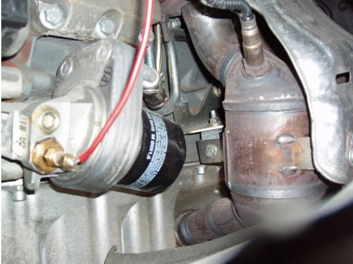
Αισθητήρας Θερμοκρασίας λαδιού, τοποθετημένος σε κινητήρα Alfa Romeo 2.0 TS
