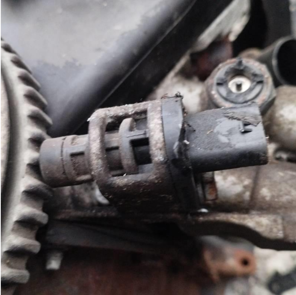
Αισθητήρας θέσης στροφάλου, μαζί με το δαχτυλίδι διέγερσης.
