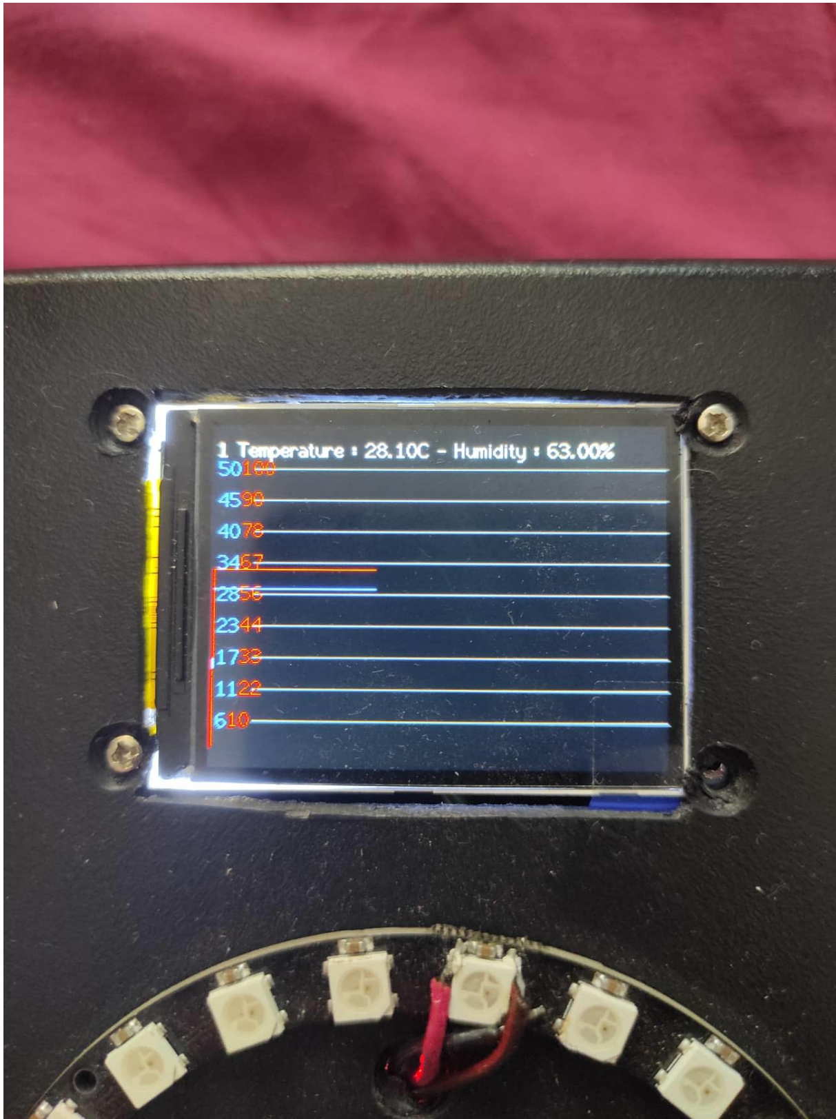
Σχήμα 3.19 Δεύτερο παράθυρο της οθόνης OLED
