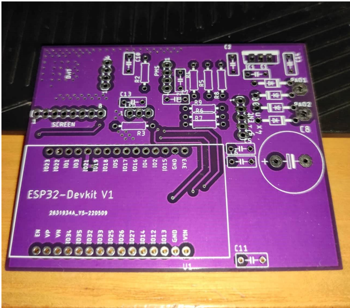
Σχήμα 3.15 PCB πλακέτα ανιχνευτή σωματιδίων
