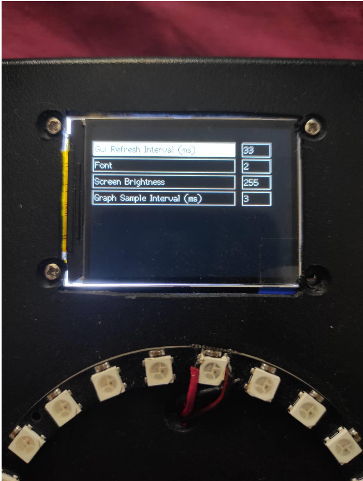
Σχήμα 3.23 Ρυθμίσεις οθόνης OLED
